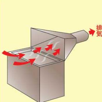
局所排気装置(外付け式)の例
