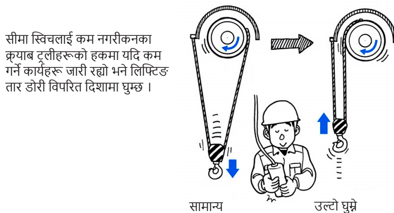
चित्र 2-26 लिफ्टिङ (उठाउने)को लागि तार डोरी उल्टो घुमाउने
