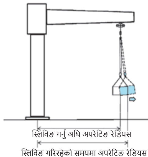
चित्र 4-9 केन्द्रापसारक बलको कारणले उचालिएको भारको बाहिरतर्फको चाल र अपरेटिङ रेडियसमा आउने परिवर्तन
