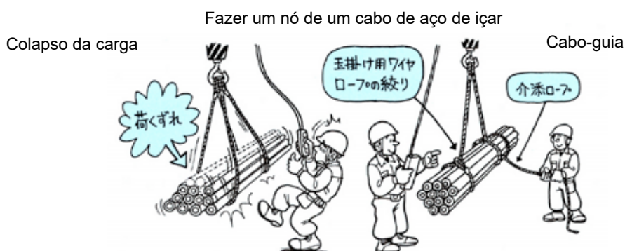
Fig. 2-33 Verificar a condição dos cabos
