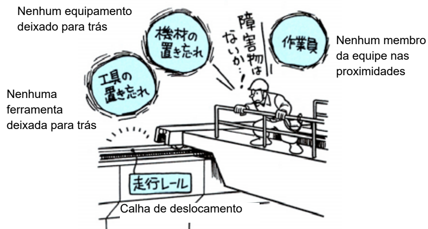
Fig. 2-8 Inspeção de obstáculos
