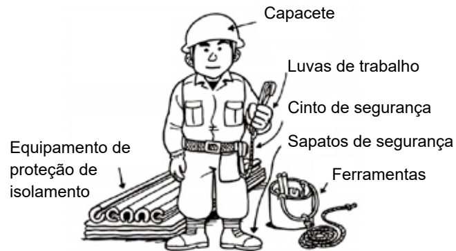
Fig. 2-48 Vestuário adequado com o equipamento de proteção
