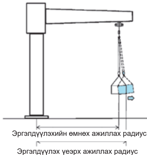
Зур. 4-9 Өргөгдсөн Ачааны Гадагш Чиглэсэн Хөдөлгөөн ба Төвөөс Зугтах Хүчний улмаас Ажиллах Радиуст Орсон Өөрчлөлт
