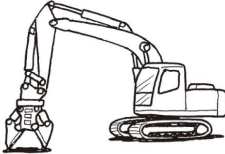
② Bersihkan lumpur atau tanah yang menempel di alat pemotong rangka baja, lakukan pengecekan kebocoran oli, baut kendur, pisau cutter yang retak, atau keabnormalan lainnya.
