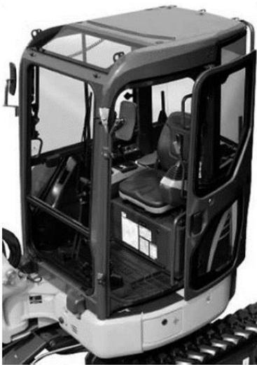
Gambar 3-9 Mesin alat berat dengan struktur alat pelindung saat jatuh
