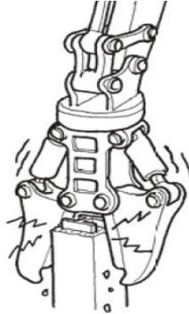
⑮ Jangan merubah arah mesin utama dengan menekan tanah menggunakan alat pemotong rangka baja. Selain menjadi penyebab kerusakan alat pemotong rangka baja dan mesin utama, dapat menyebabkan mesin utama kehilangan keseimbangan.
