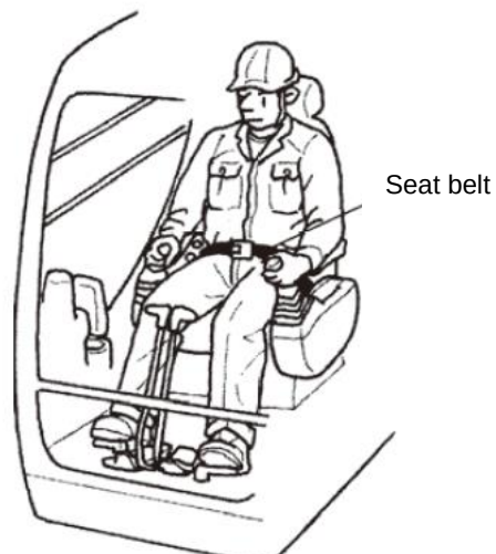
Larawan 3-18 Halimbawa ng seat belt na ginagamit sa Rollover Protection Structure
