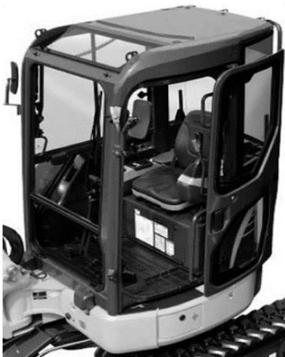
Hình 3-19 Máy xây dựng dạng xe có cấu tạo bảo hộ khi lật úp
