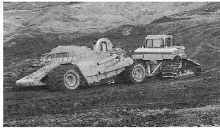
Hình 6-6 Tình trạng làm việc của máy cạp kiểu được kéo
