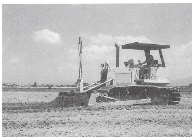
Hình 6-4 Ví dụ về thiết bị điều khiển lưỡi ủi
