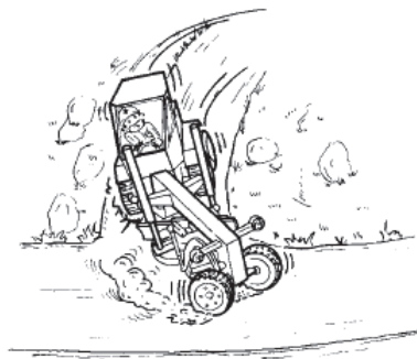
図9-19 遠心力による転倒
