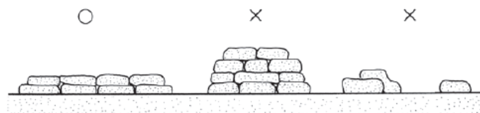
図6-83 撤出作業の例
