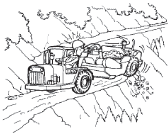
図6-79 遠心力による脱輪注意
