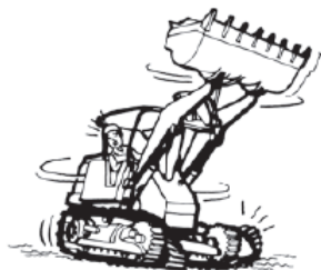
図4-3 高速でその場旋回の留意点
