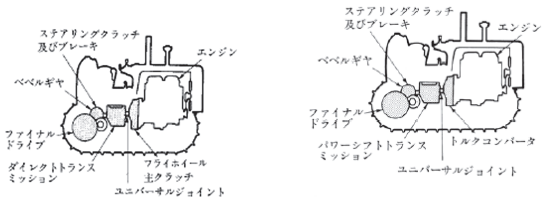
図3-1 クローラ式トラクター構造の例
