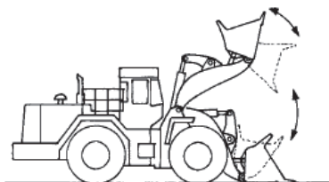
図6-30 リフトアームとバケットの操作例
