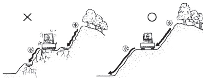
図6-8 法面排水の例
