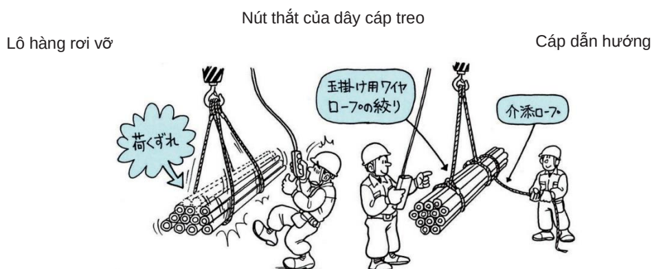
Hình 2-33 Kiểm tra tình trạng cáp
