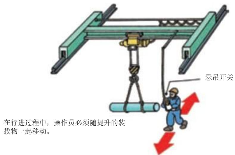
图 1-3 悬挂在大梁固定位置上的悬吊开关
