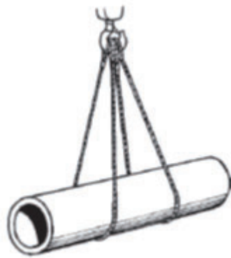
Fig. 2-27 Isang-Pihit na Pagkakabit gamit ang Dalawang-pantali at Apat-na-punto
