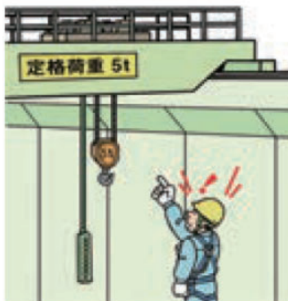
Fig. 5-1 Ipakita ang halimbawa ng na-rate na karga sa overhead na paglilipat na crane
