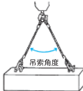
图3-4 两点双绳吊索的吊索角度
