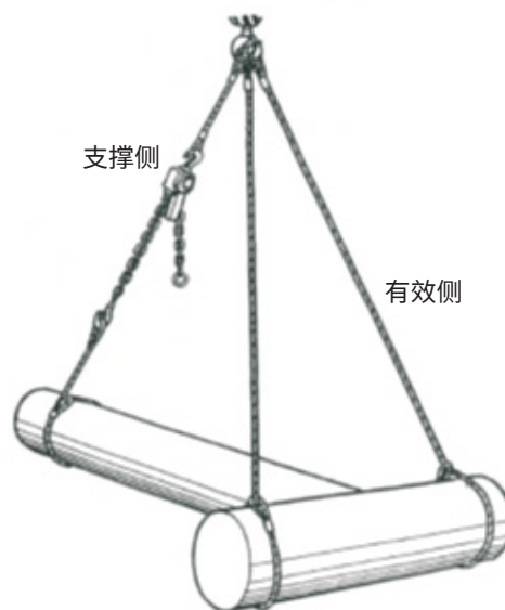
图5-23 用其他起吊配件调节的吊索： 有效侧：通过吊环紧固
