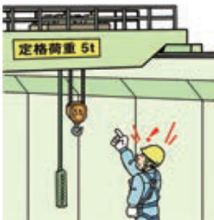
图5-1 高架移动式起重机额定载荷的显示示例
