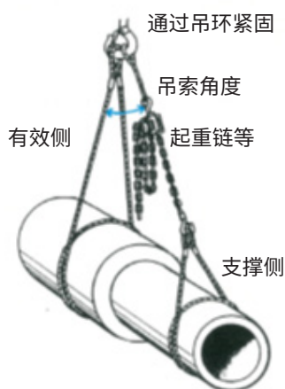
图5-22 用其他起吊配件调节的吊索： 有效侧：单圈吊索
