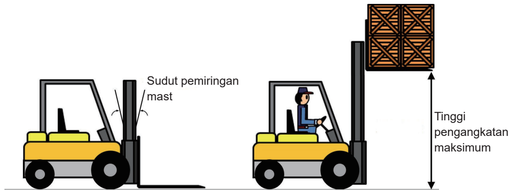
Gbr. 1-3 Sudut pemiringan mast dan tinggi pengangkatan maksimum
