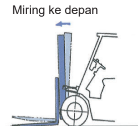
Gbr. 3-9 Memiringkan Mast ke Depan
