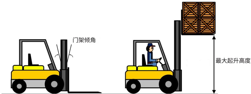
图1-3 门架倾角和最大提升高度
