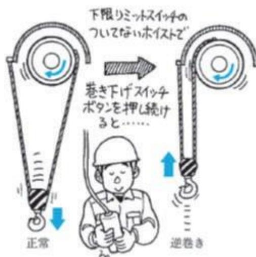
図 2-26 巻き上げ用ワイヤロープの逆巻き
