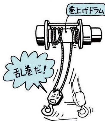
図 2-38 振れているフックの巻上げ禁止
