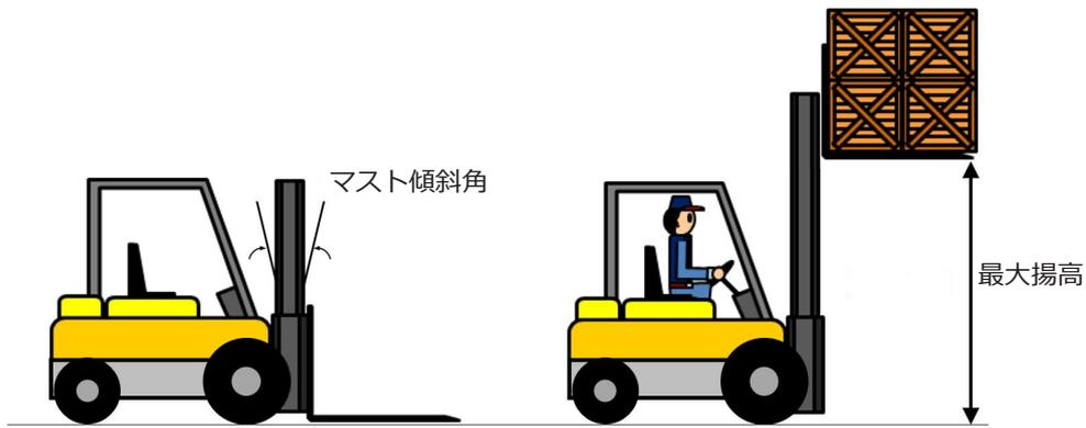
図 1-3 マスト傾斜角と最大揚高
