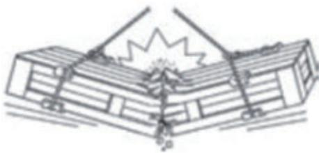
図 5-9 つり荷の破損
