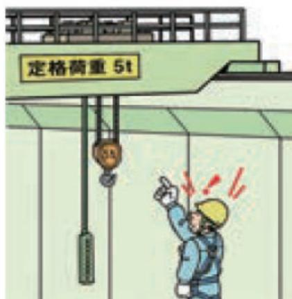
図 5-1 天井クレーンの定格荷重の表示例
