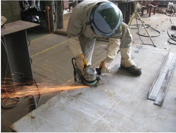
Pekerjaan memoles gurinda
