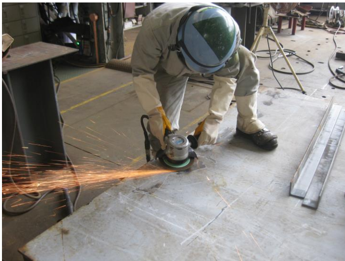
Pekerjaan gurinda 85dB
