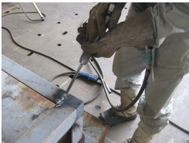
Công việc gỡ xỉ hàn bằng đục xỉ
