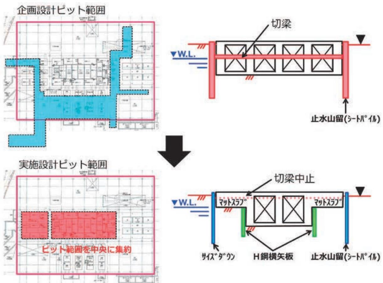
図-9 企画・設計時に地下躯体（地下ピット）を集約し、切梁と重機の接触リスク、湧水によるリスクを低減させた事例
