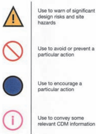
図-6 設計におけるリスク等の記号 (CDM2015 A Practical Guide for Architects and Designers, RIBA Publishing, p. 79.)
