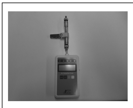
活性炭管を装着したサンプリングポンプ例
