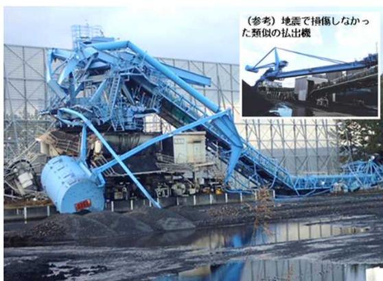
倒壊した石炭払出機
