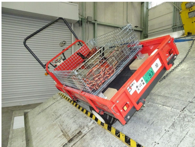
静的転倒角測定試験（11/21～22）の様子
