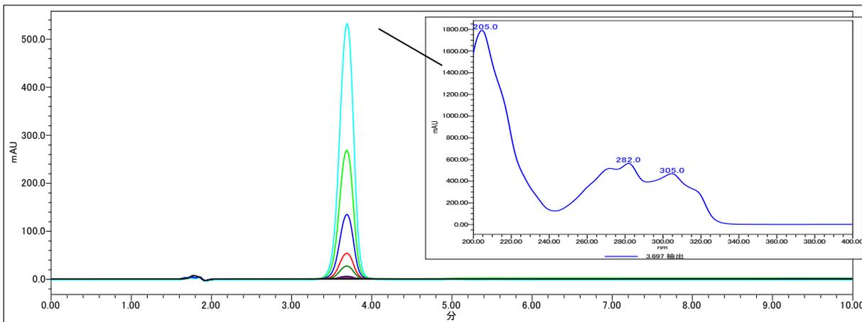
図5 3-(アルファ-アセトニルベンジル)-4-ヒドロキシクマリン標準溶液(0-100 µg/mL)のクロマトグラム重ね書きおよびスペクトル
