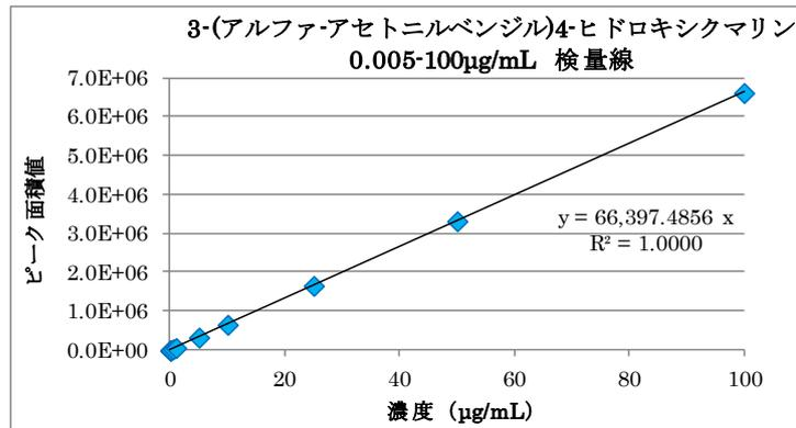
図 6-2 検量線(0.005-100  $\mu\text{g/mL}$ )
