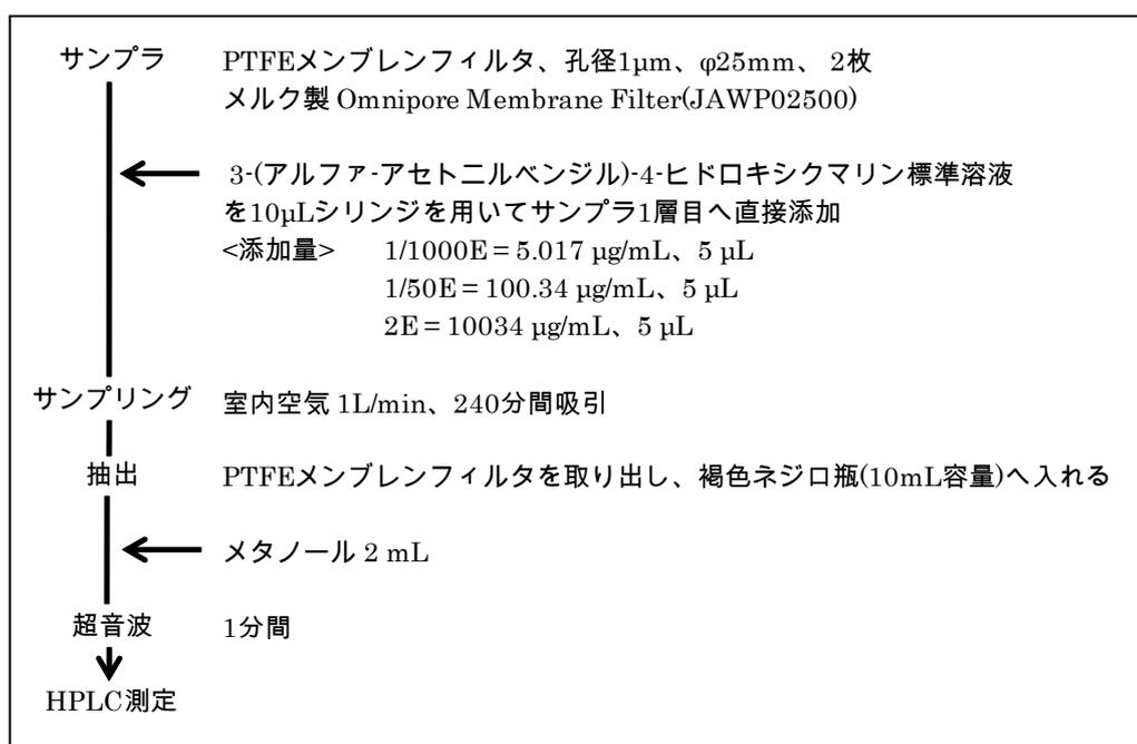
図2 添加回収率(通気試験)の操作フロー
