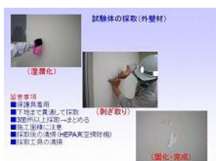
図－４ サンプルング例（外壁材）
