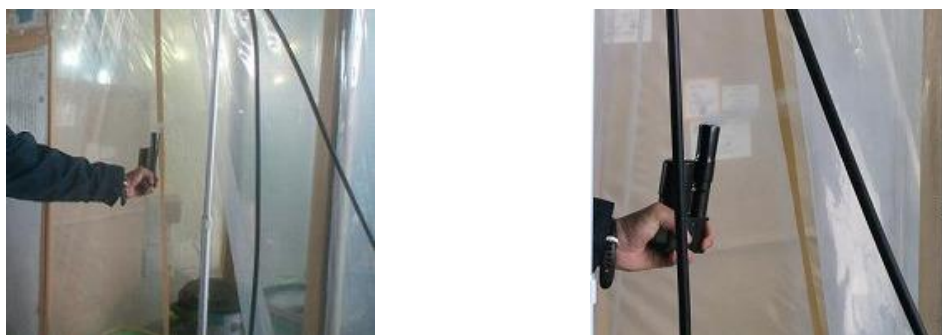
図-19 セキュリティーゾーンの入り口の気流方向の確認
