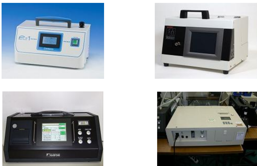
図-23 繊維状粒子自動測定機の例
