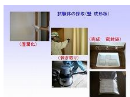
図－５ サンプルング例（成形板）
