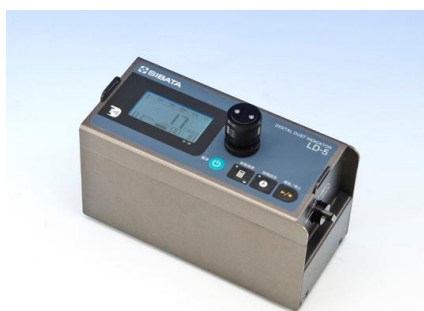
図-21 粉じん相対濃度計の例
