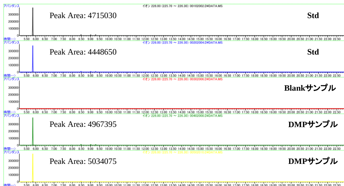
図 16 DMP 法の予備試験結果（マスイオンクロマトグラム：m/z 226）
