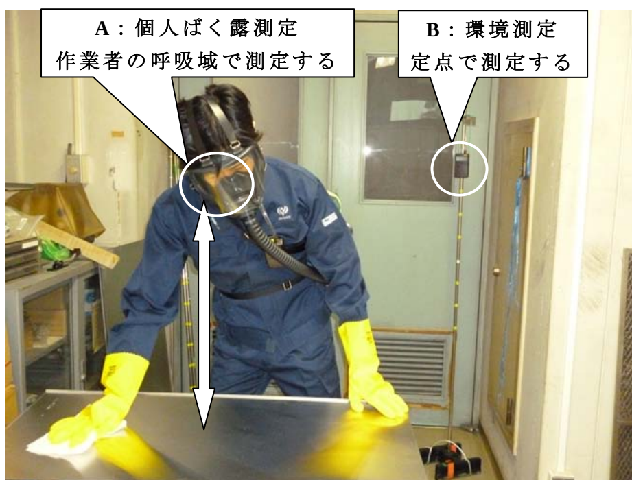
図 7. 実施したブランケット拭き取りの模擬作業
