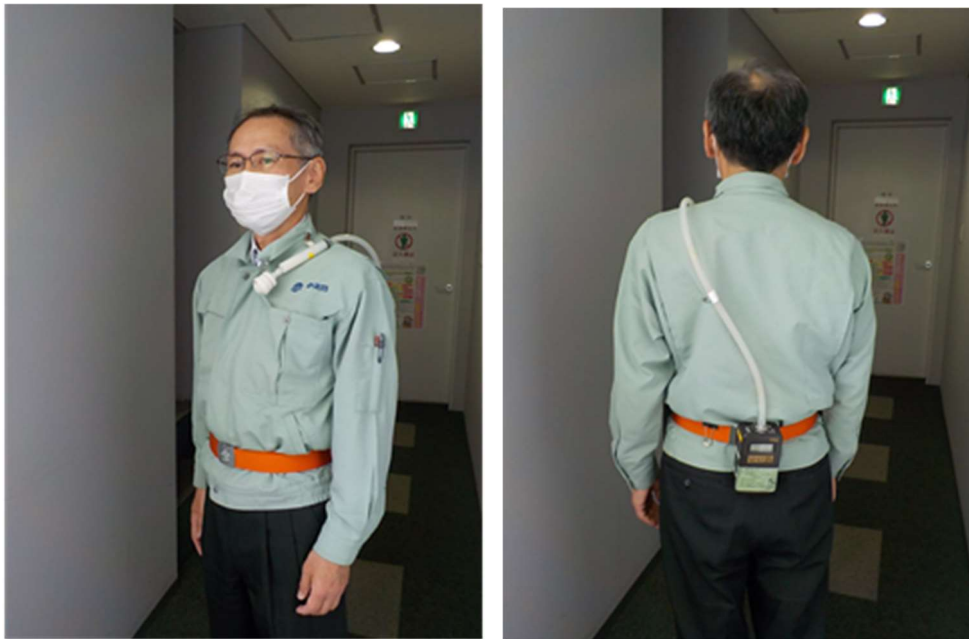
図1 個人ばく露濃度測定の例
