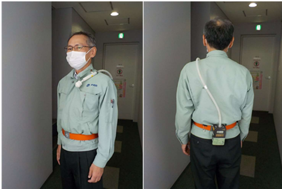
図3 ダイオキシン類測定で使用したサンプリング機器
