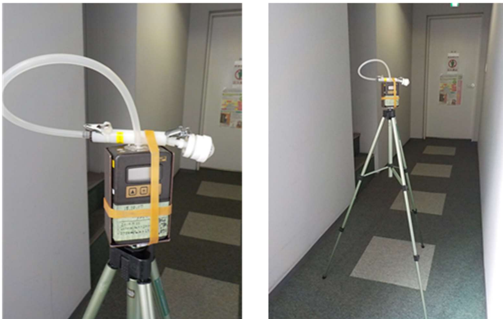
図 2 作業環境測定の総 PCB A 濃度測定の例
