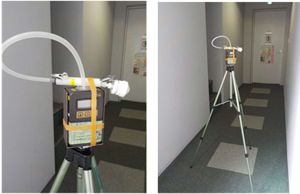
図1 PCB作業環境測定及び併行測定で使用したサンプリング機器
