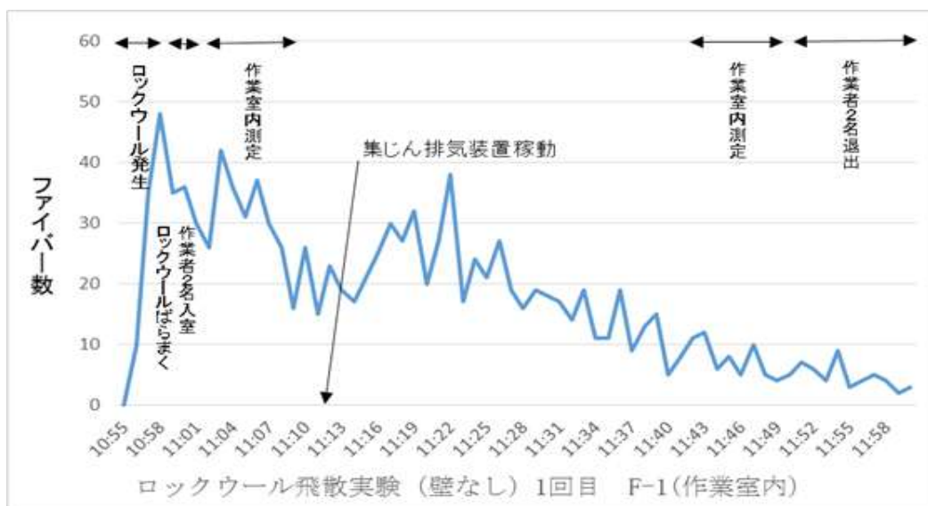
図7 ロックウール飛散実験（壁なし：1回目）（作業場内のF-1の測定結果）
