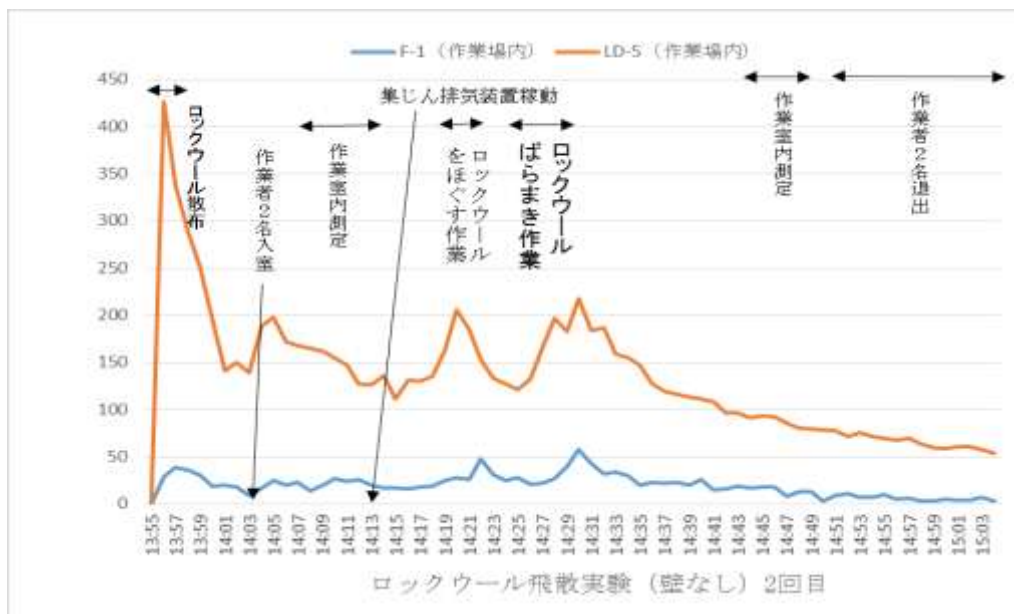
図 11 ロックウール飛散実験（壁なし：2回目）（作業場内の F-1、相対濃度計の結果）
