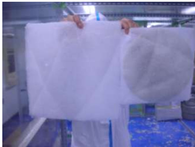
写真2 新品（左）と目詰り（右）したフィルター
