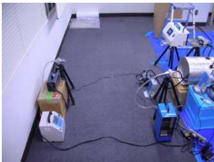
写真2 排気口の測定機材の設置状況
