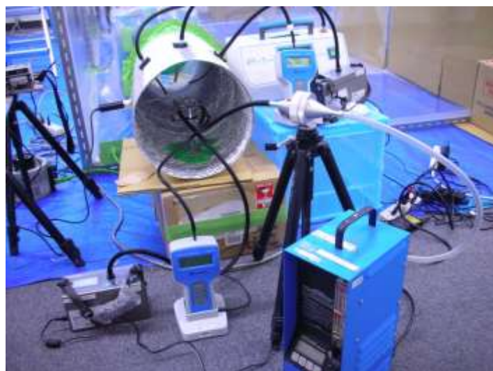
写真1 排気口の測定機材の設置状況
