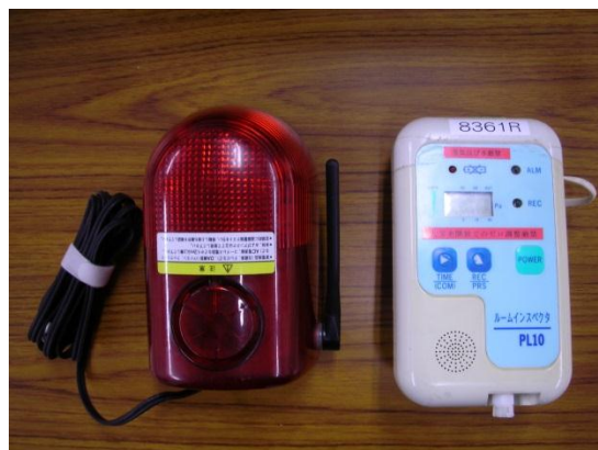
写真5 パトライト警報発信装置付き差圧計
