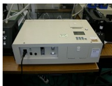
図-23 繊維状粒子自動測定機の例
