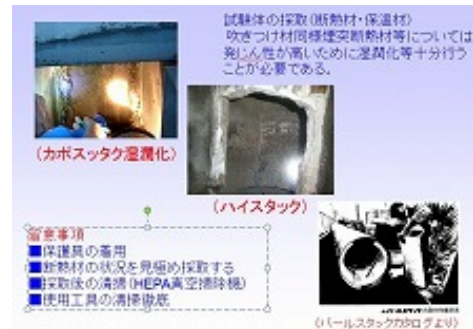
図－3 サンプルング例（煙突断熱材）
