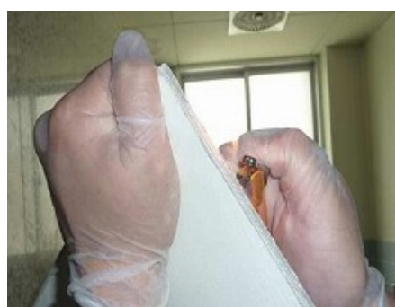
写真Ⅱ－8 燃焼試験
