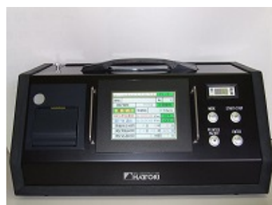
図-23 繊維状粒子自動測定機の例
