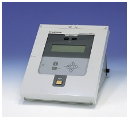
図－14 労研式マスクフィッティングテスター（例）
