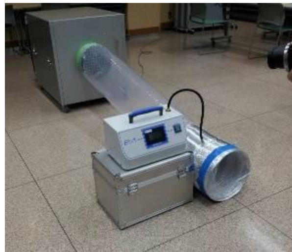
リアルタイムファイバーモニターを使用したリアルタイム漏洩監視例
