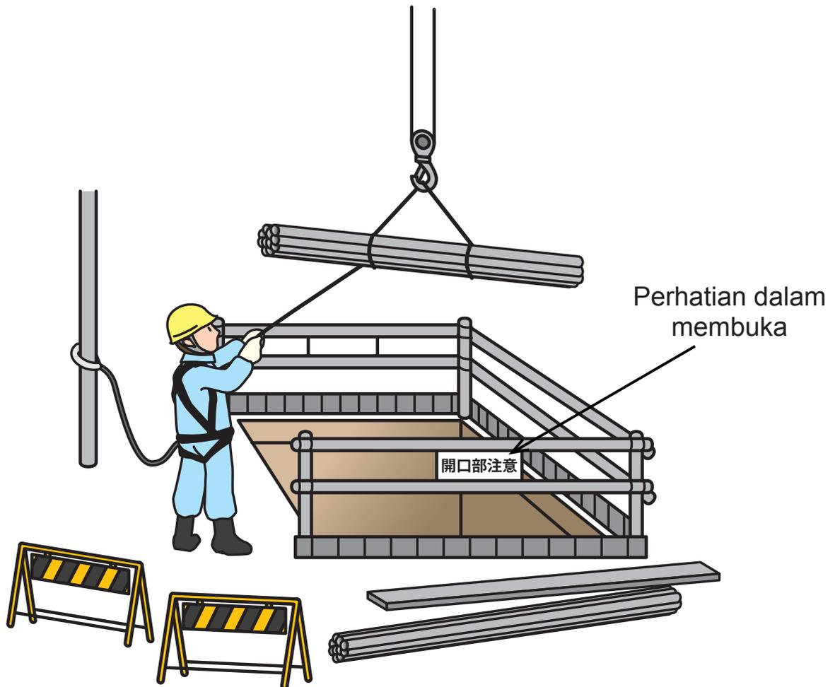
Saat melepas pegangan tangan / palang tengah lubang, diperlukan sistem penangkapan jatuh perorangan (perlengkapan pencegahan jatuh) dan jangan pernah mengaitkan perlengkapan tersebut ke pegangan tangan. Selain itu, jangan naik dan turun dengan menggunakan pegangan tangan atau palang tengah untuk melangkah.
