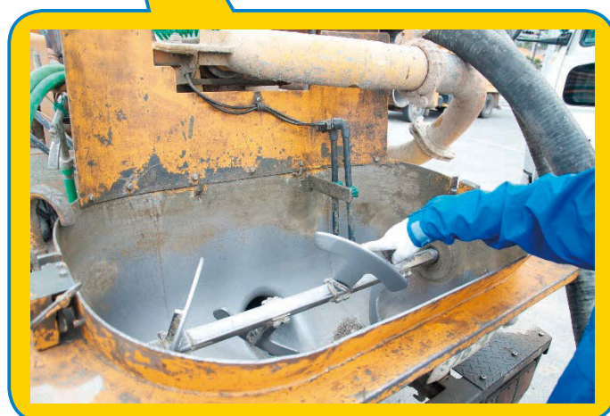
脚从过滤网的缝隙掉落，被卷入搅拌器的事故示例
