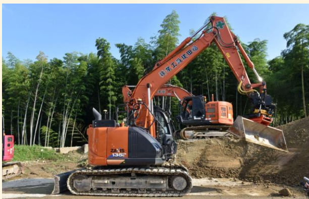
ショベルカーの先端が360度回転し自由な角度に傾くアタッチメント「チルトローテーター」
