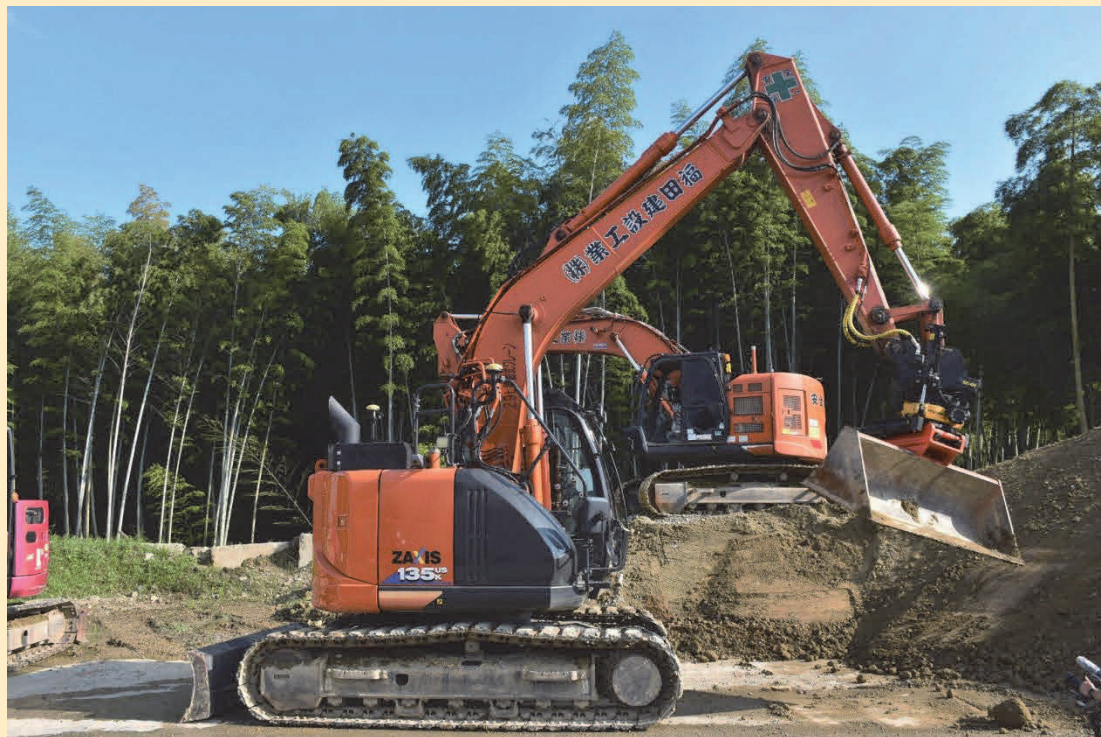
ショベルカーの先端が 360 度回転し自由な角度に傾くアタッチメント「チルトローテーター」
