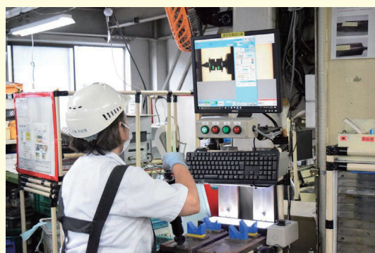
誰もが検査工程の仕事ができるよう内製した画像判断装置
