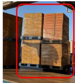
2枚差しフォークリフト (従来の2倍運搬可能) ※一度に2列分運んでいる
