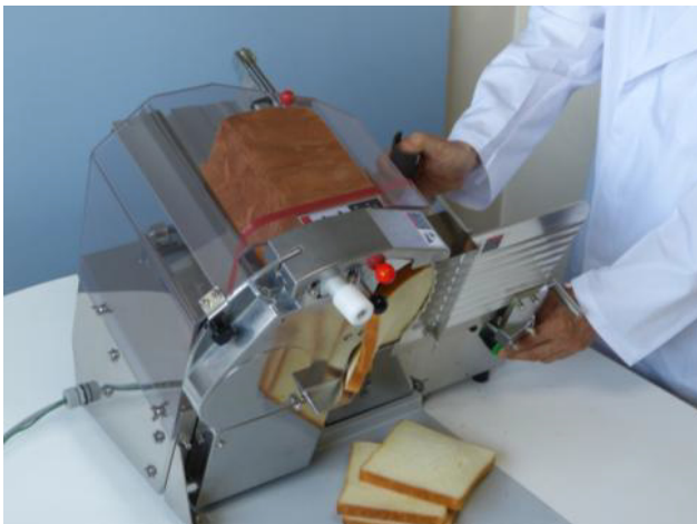
食品加工用切断機（両手操作式制御装置付きスライサー）
