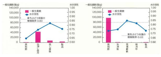
荒節製造工場 A における工程毎の 一般生菌数と水分活性の変化
