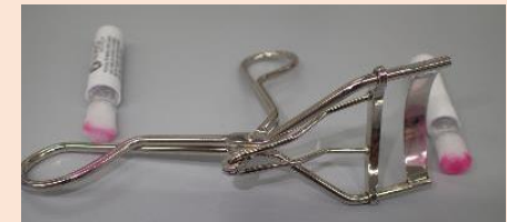
スポットテストによるNiの検出法
