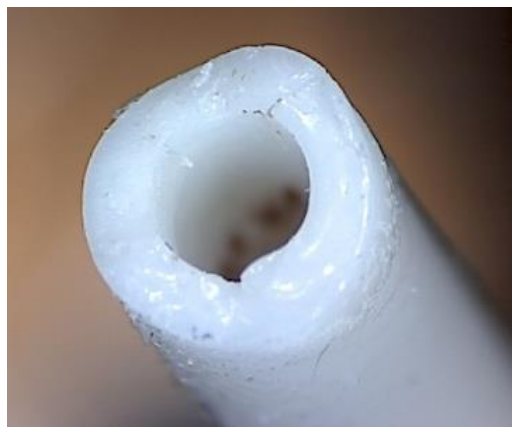
カテーテルの損傷状態
