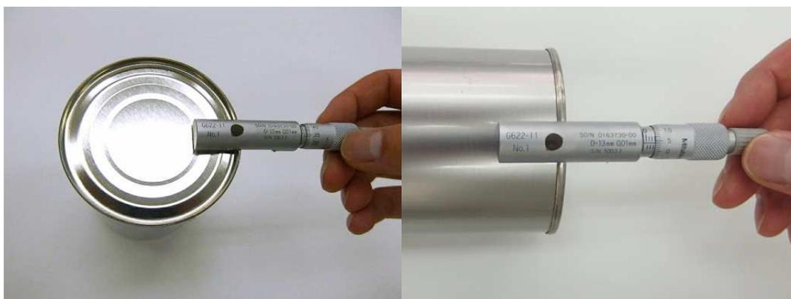
写真6 二重巻締の外部寸法測定
