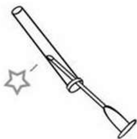
プロテクターの削れ片が、採血針の針管にくっついている状態
