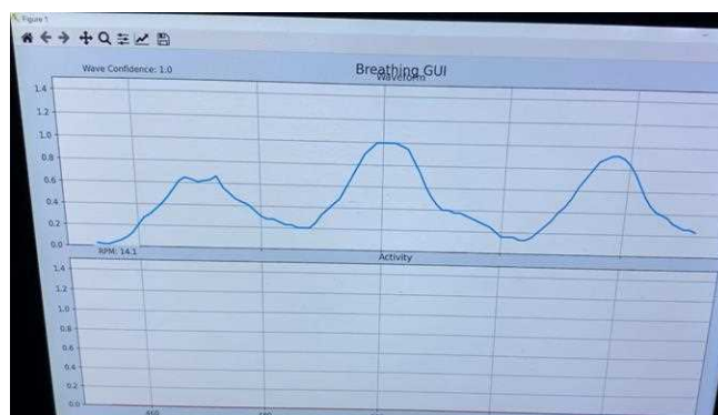
(図 3) 呼吸数モニター波形
