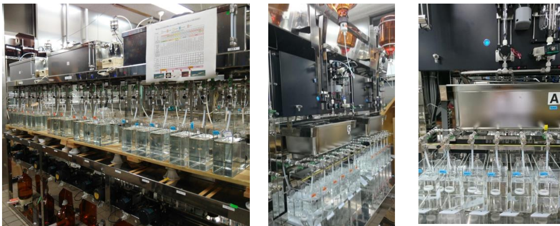
図 1-1 流水式装置 (左：1号機、中央：2号機、右：2号機・ふ化器をセット)
