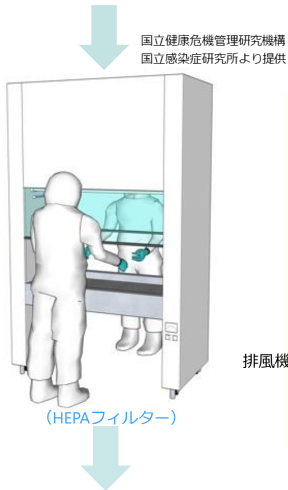
両面に扉が設置されたキャビネット型の局所排気装置
